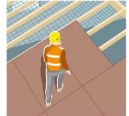
Regel 3: Wir sichern uns gegen Absturz ins Gebäudeinnere ab 2m Absturzhöhe.
