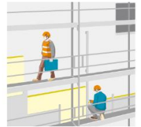
Regola 6: Per i lavori sulle facciate utilizziamo un'impalcatura sicura o una piattaforma di lavoro mobile elevabile.
